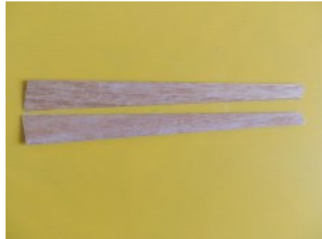
28. Die Querruder aus 8 mm Balsa hobeln und schleifen. (innen 25 mm, aussen 50 mm)
