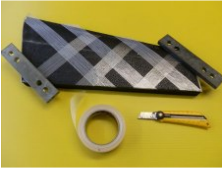
25. Tape auf Ober- und Unterseite kreuzweise auflegen
