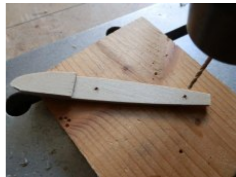
12. Löcher bohren, 2 mm
